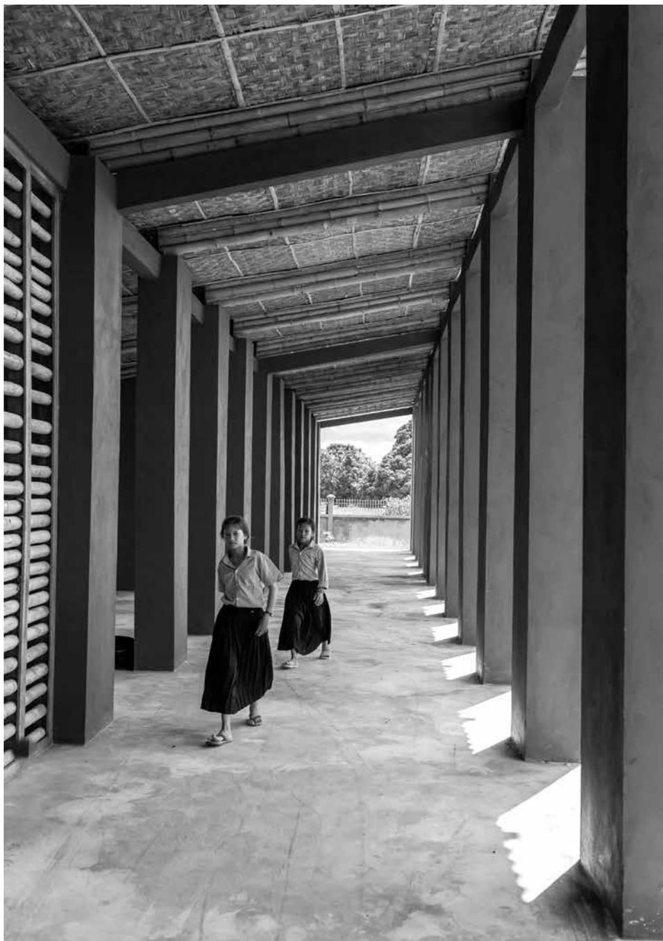
4 | Scuola secondaria del villaggio Roong. Il corridoio/portico ha una profondità di tre metri e un'altezza di cinque metri al colmo. Foto Bumuo Pictures. Courtesy ASF Italia.
